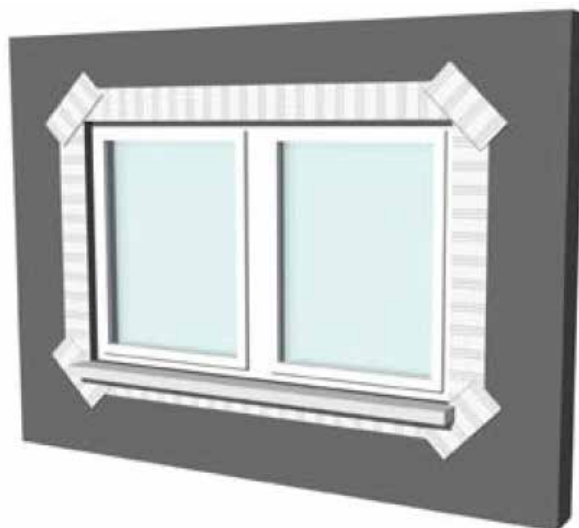
Obrázek č. 10 Vyztužení okrajů stavebních otvorů sklotextilní tkaninou
